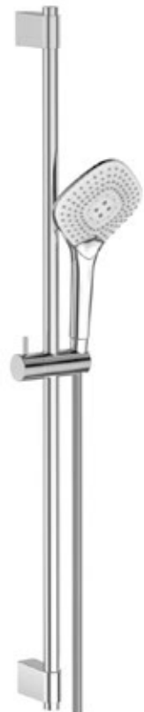
Brausestangenset Handbrause 3 Strahlarten (Umstellung per Taste) mit Antikalk, Brausestange 90 cm, Kunststoff-Brauseschlauch silber 175 cm, Chrom AQARVABS90.2 217,-
